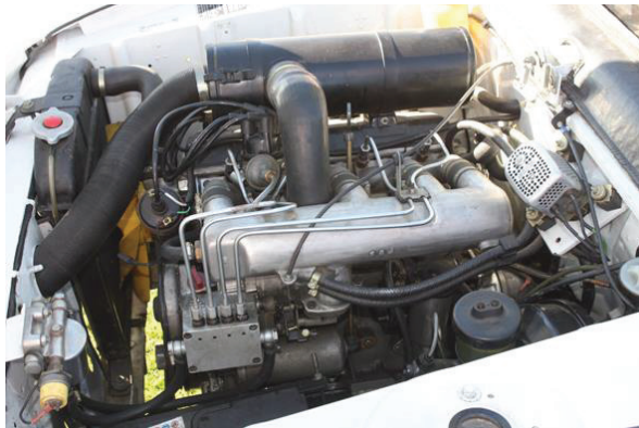
Kugelfischer injection in the 404
