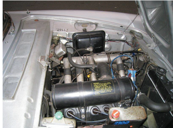
Kugelfischer injection in the 404
